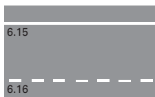
6.15 Ligne de bordure 6.16 Ligne de guidage
