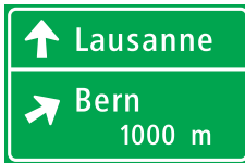
4.67 Premier indicateur de direction avancé, destiné aux ramifications
