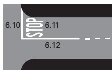
6.10 Ligne d'arrêt 6.11 Stop 6.12 Ligne longitudinale continue
