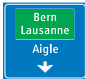
4.41 Panneau de présélection au-dessus d'une voie de circulation sur route principale
